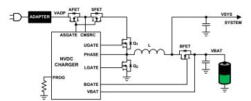
FIGURE 2. NVDC CHARGER CONFIGURATION
